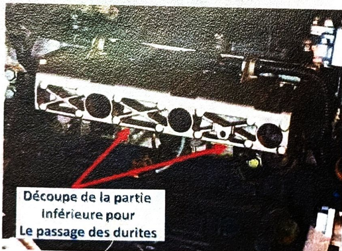
PHOTO 8 - Protection alu de rampe d'injection
