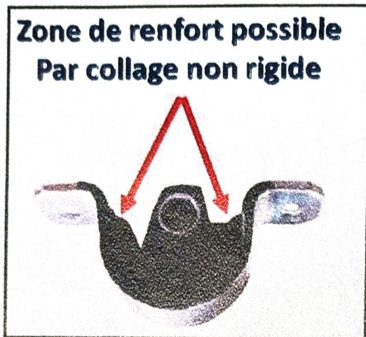
PHOTO 9 - Silentbloc d'origine sous longeron (traverse)
